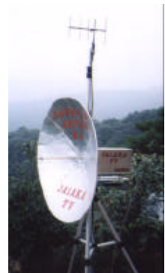
日和田山から筑波山に向けた 10GHz ダンボラアンテナ
