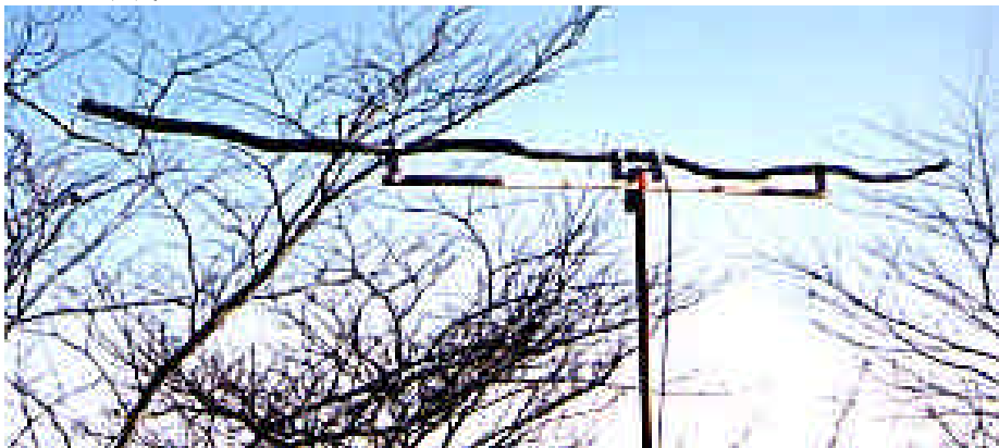
伊豆ヶ岳山頂でのピンチョーテナの実験 上 50MHzハーフラムダダイポール
