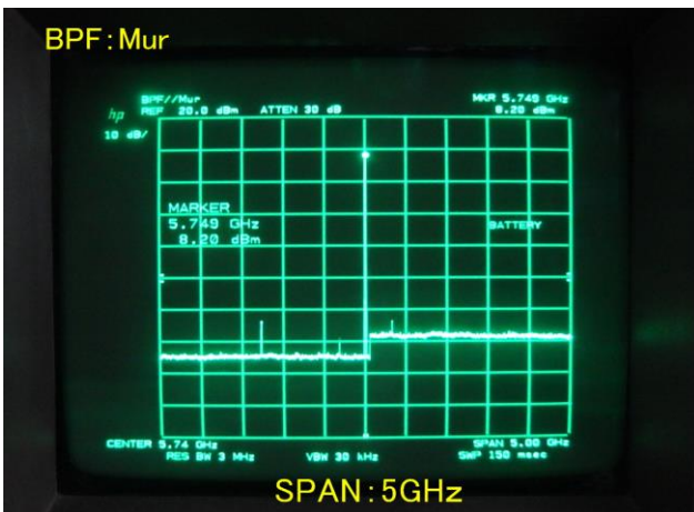
送信部 ムラタ製BPF SPAN : 5GHz 【TX : IF=1280MH (+10dBm)/Lo:4480MHz】
