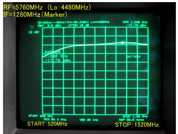
5GHz帯 T/R IF(1280MHz)受信周波数帯域 (2段LNA付き)
