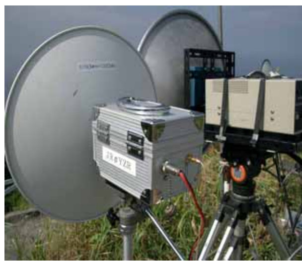
右側:10GHz帯トランスバーター
