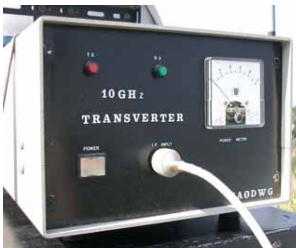
数ワットの10GHz帯トランスバーター
