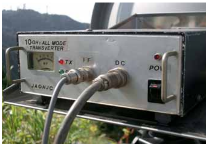
10GHz帯トランスバーター1wタイプ (Lo:1wとHi:数w切り替え可能器)
