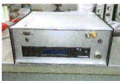
XHEAD-2 を利用してコンパクトにまとめた例。収容方法の関係で XHEAD-2 は逆さに実装
