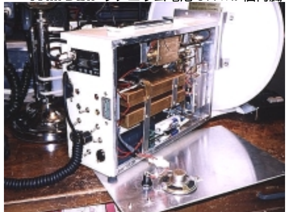
5GHz 550mW, 10GHz 130mW デュアル FM 31cm Dish リチウム電池 3A × 2 個内臓
