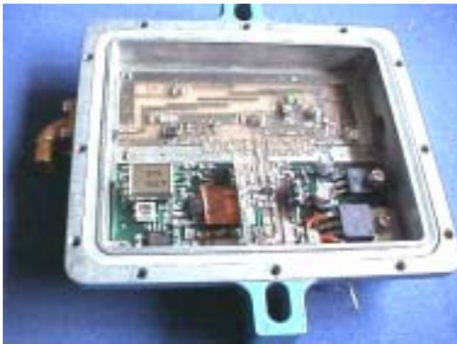
薄い銅版を仕切板にハンダ付けで固定(1cm角)
