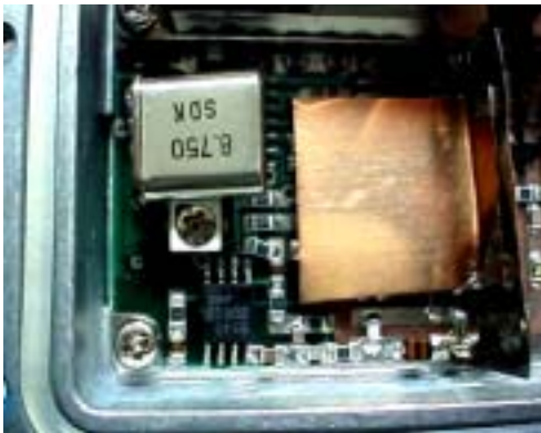
プリスケラの上に1cm角の銅版を乗せ スペアナで確認 高調波が約10dBダウン!
