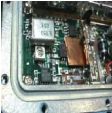
プリスケラの上に1cm角の銅版を乗せ スペアナで確認 高調波が約10dBダウン!
