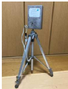
左図 三脚上に取り付けた自作水平仰角ローテーター
