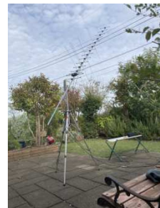
右図 15 エレ軽量改造した八木アンテナ
