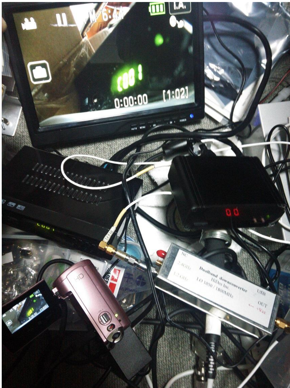
1265MHz 送信でのループテストの様子
